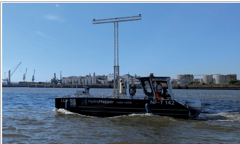
Abb. 1: Messboot mit Laserscanner, photogrammetrischem System und Fächerecholot
