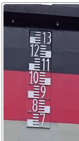
Abb. 1: E-Teilung am Rumpf des Schiffes
