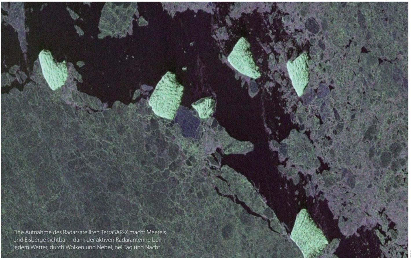
Eine Aufnahme des Radarsatelliten TerraSAR-X macht Meereis und Eisberge sichtbar – dank der aktiven Radarantenne bei jedem Wetter, durch Wolken und Nebel, bei Tag und Nacht
