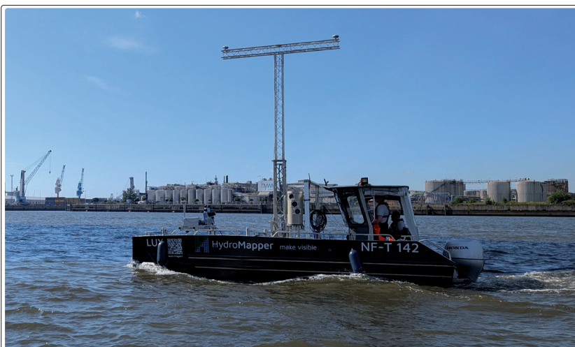
Abb. 1: Messboot mit Laserscanner, photogrammetrischem System und Fächerecholot
