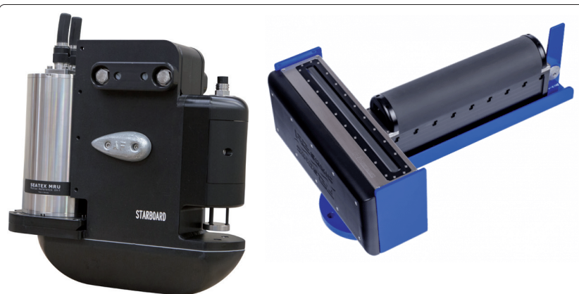
Abb. 3: Der Schallgeber des GeoSwath4 500 kHz in der Aufsicht (links). Der Schallgeber des R2Sonic 2026 V+ von der Unterseite aus betrachtet (rechts)
