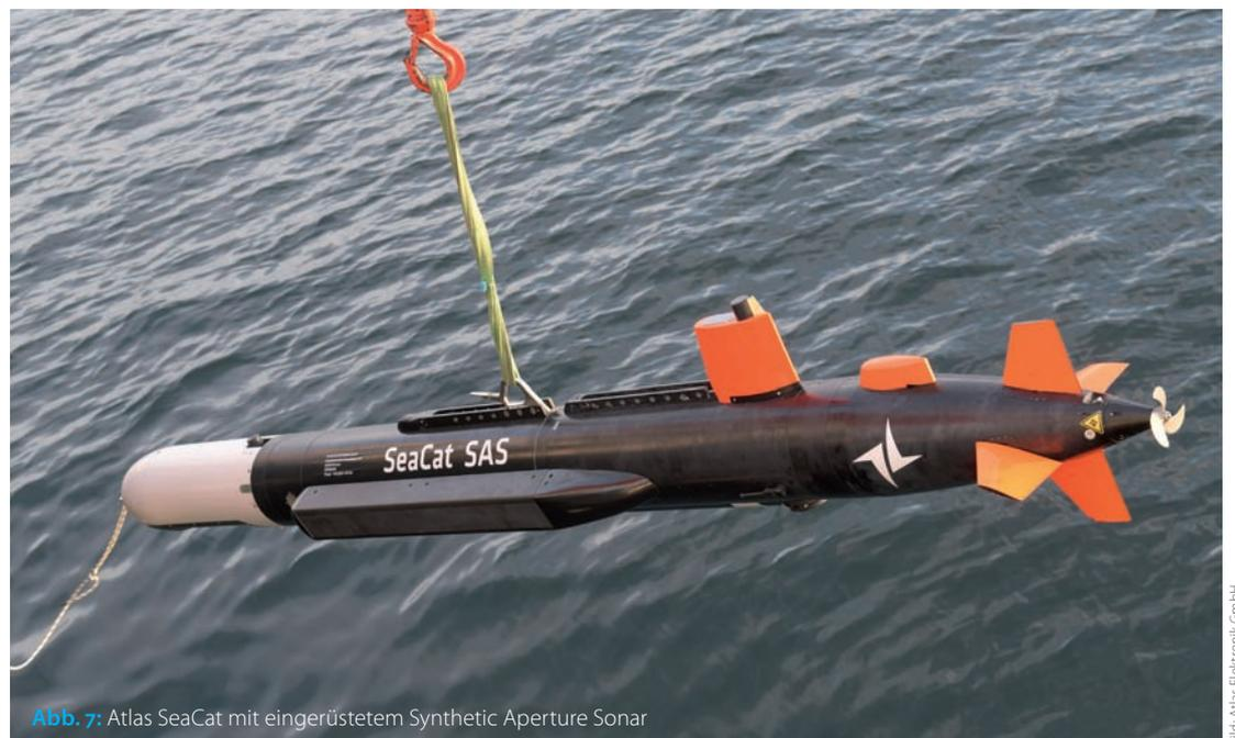
**Abb. 7:** Atlas SeaCat mit eingerüstetem Synthetic Aperture Sonar
