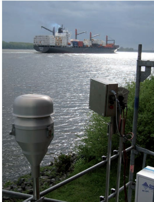
Abb. 2: Messstation vor Wedel, die Teil eines größeren Schiffsabgasmessnetzes ist
