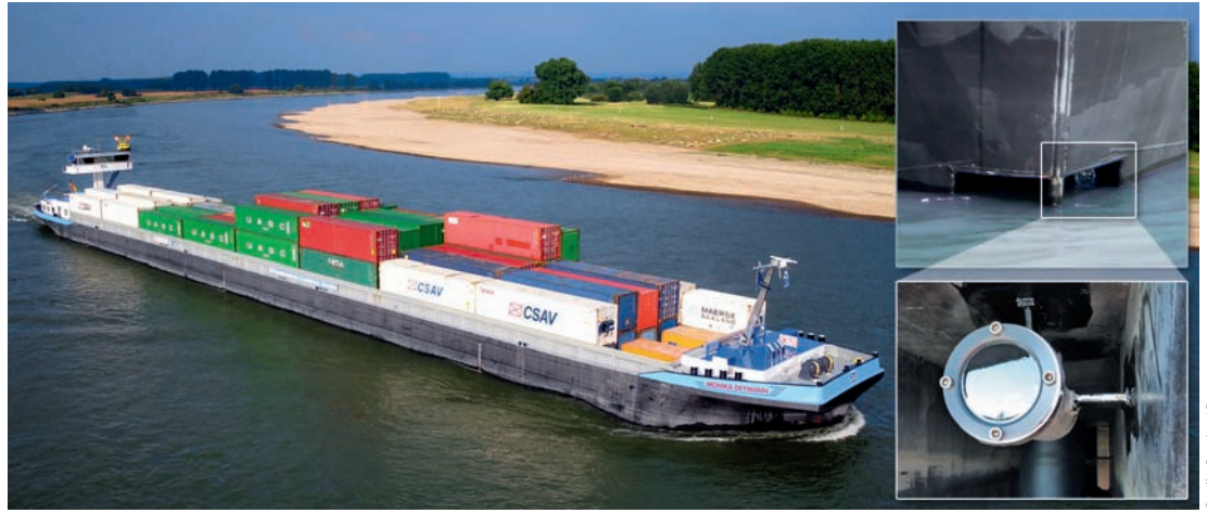
Abb. 2: GMS »Monika Deymann« mit 1D-Strömungssensor im Bugstrahlkanal (rechts)
