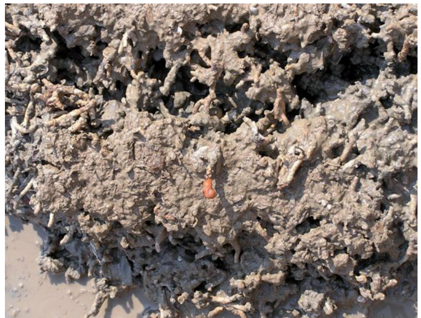
Abb. 1: Bodenprobe aus einem dichten Geflecht kalkiger Korallenröhren, das mit Schlick aufgefüllt ist
