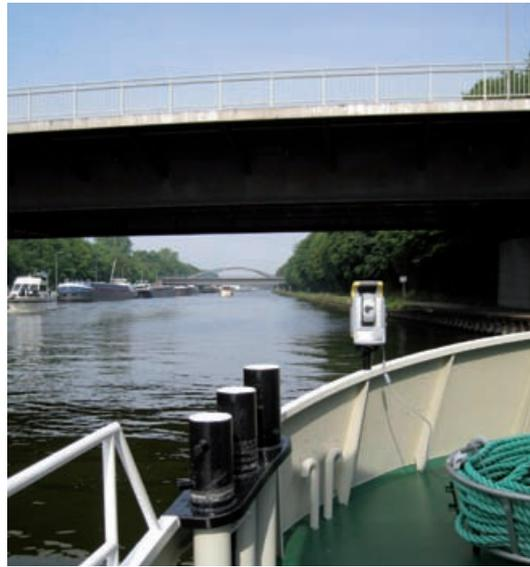
Abb. 5: Tachymeter an Bord von PS »Visurgis«
