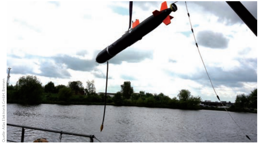
Abb. 2: ATLAS SeaCat mit Raman-Spektroskop. Der Sensorkopf hängt am unteren Ende des Kabels und kann, in der oberen Sedimentschicht geschleppt, die Messung durchführen
