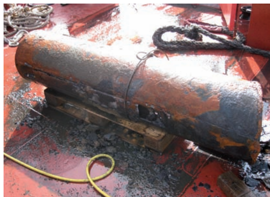
Abb. 2: Britische Grundmine Mark VII, welche durch Abtrennen des Gerätekastens mittels Schneidladung sprengtechnisch entschärft wurde
