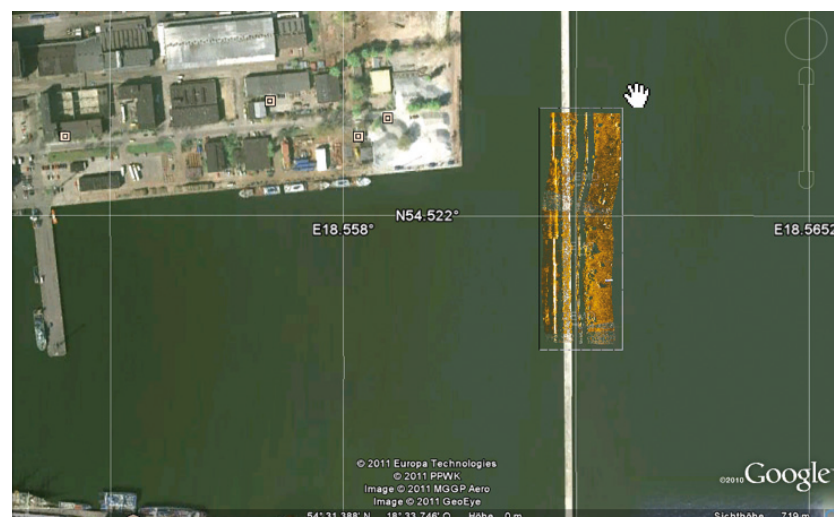
Abb. 6: Darstellung der Side-Scan-Sonar-Daten in Google Earth mit hinterlegtem Luftbild
